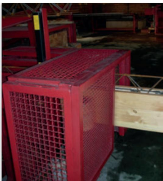
Attraverso il confezionamento del solaio realizzato integralmente in stabilimento è possibile non solo controllare le varie fasi di accoppiamento ed assemblaggio del traliccio metallico nella trave lamellare ma anche apporre per punzonatura impressa direttamente all'estradosso dei travetti tutti gli elementi identificativi previsti dalle normative in vigore.
