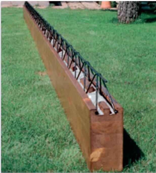
Il “Solaio Compound®” basa la propria filosofia nel far lavorare in sinergia legno e calcestruzzo sfruttando la resistenza a trazione del primo e quella a compressione del secondo, portando quindi il sistema ai massimi risultati possibili in termini di efficienza globale.
