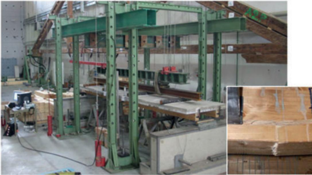
Fig. 12 Apparato di prova e tipica rottura di una delle travi lamellari (provino S15M1a).
