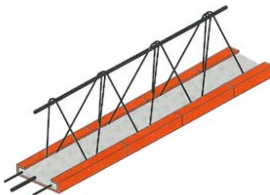
Fig. 5 - Travetti armati a traliccio con fondello in laterizio.
