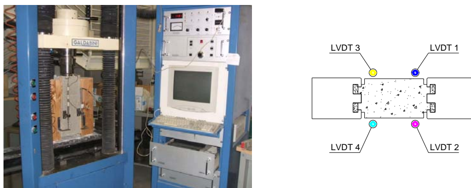
Fig. 9 Macchina di prova "Galdabini" e disposizione della strumentazione durante la prova.
