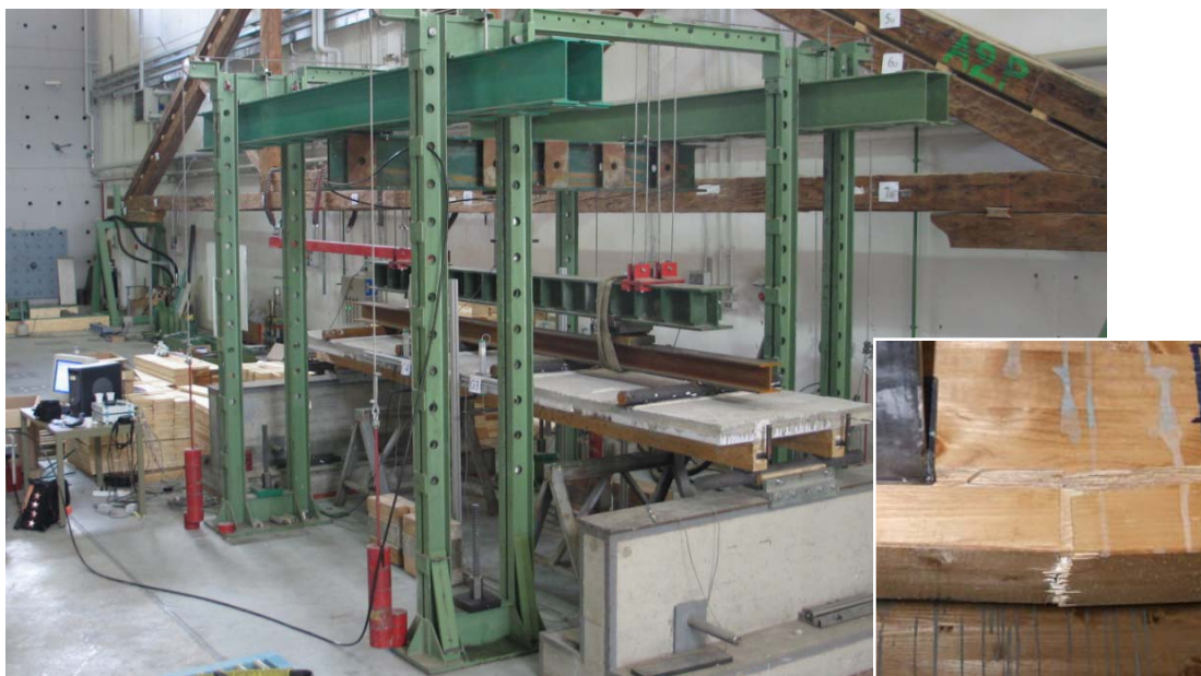
Fig. 12 Apparato di prova e tipica rottura di una delle travi lamellari (provino S15M1a).
