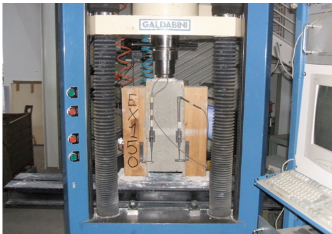
Macchina di prova "Galdabini" e disposizione della strumentazione durante la prova.
