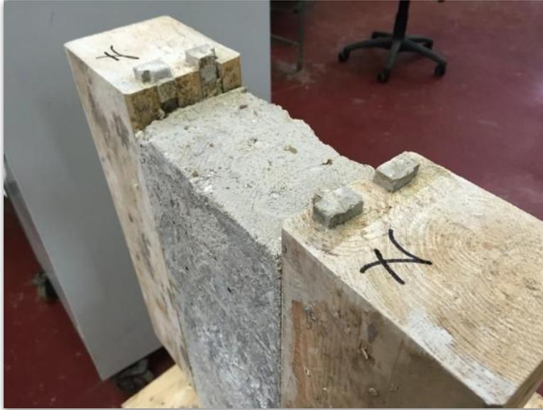
Il Solaio Compound è concepito appunto in modo tale da poter dissipare elevati quantitativi di energia dinamica tramite lo scorrimento controllato dell'elemento fragile, rappresentato dal traliccio
