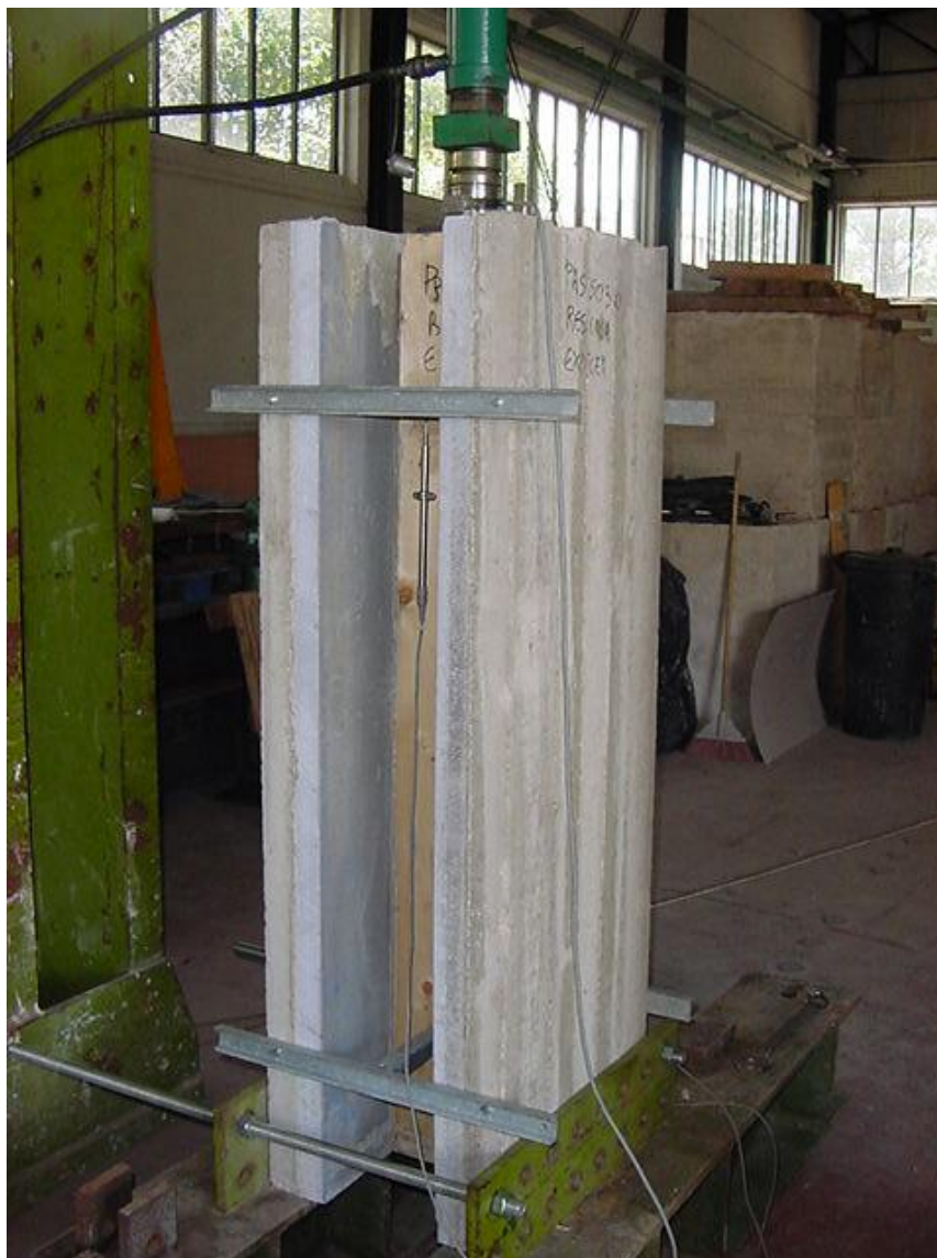
Campioni in legno lamellare e calcestruzzo armato (Solaio Compound)
